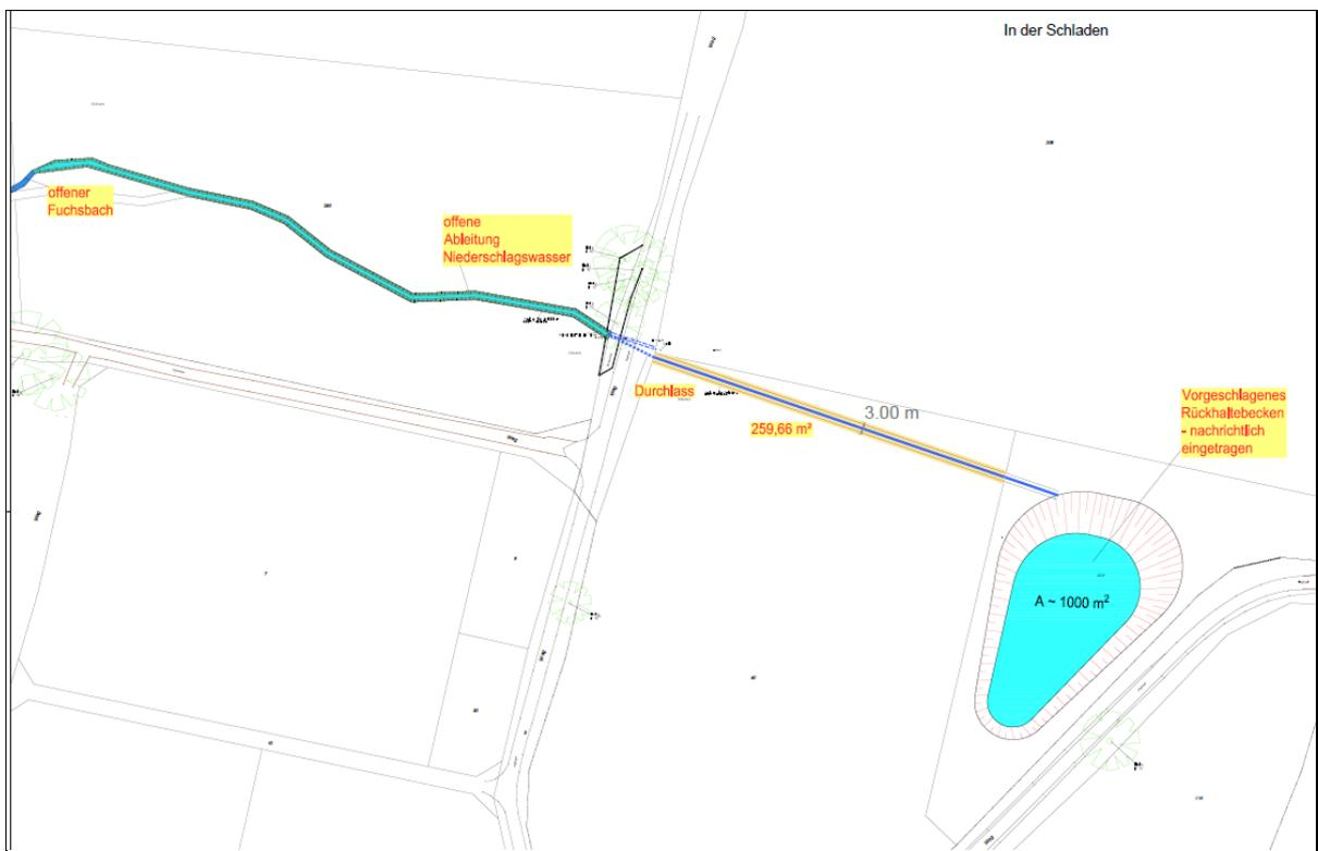
Abbildung 3: Lageplan des Regenrückhaltebeckens, Stand 27.07.2021 (Stelter, 2021).
